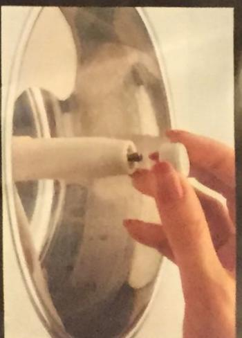
4) La pala miscelatrice è fissata da un pomolo a vite. Sull'albero della pala è montata una frizione salvamatore che entra in funzione quando il gelato è eccessivamente duro.
